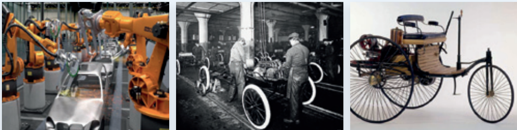
תיעוש תהליך ייצור המכוניות - מימין: 1888 מנוע הבערה הפנימית של בנץ - 5 מכוניות בשנה בייצור ידני, 1914 מודל T של פורד - 12,000 מכוניות בשנה מפס ייצור, פס ייצור רובוטי - 70 מיליון מכוניות בשנה
