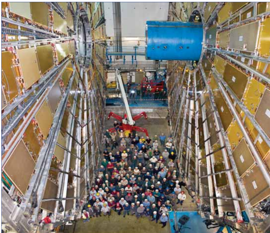
השלמת הרכבת הגלגלים הגדולים במיזם אטלס. הגלגלים בנויים מאלפי גלאים שהם פרי תכנון ובנייה ישראליים ברובם.
