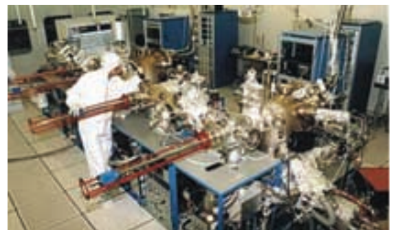
ציור 1 אפיטקסיה בקרניים מולקולריות. מערכת לגידול ולאגירה של דגמים בתוך תא ואקום גבוה במיוחד, שנועדה לגידול מבוקר של שכבות אפיטקסיליות (המתאימות לפני השריג שמתחתן) זו מעל זו בדרגת ניקיון גבוהה ומבוקרת. שכבות כאלה המיוצרות בשיטה זו או בשיטות קפדניות פחות הן הבסיס לסגים רבים של התקנים מוליכים למחצה. המערכת שבציור, במרכז בראון במכון ויצמן, משמשת לגידול גבישים ממשפחות Ga Al As 1 Ga As.
